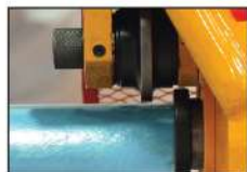
สอดท่อให้หน้าตัดท่อนับกับแนวกับหัวกรูฟ
