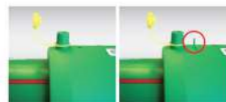
ภาพที่ 8 Indicator แสดงให้เห็นว่าการเชื่อมเสร็จสมบูรณ์ของข้อต่อ
